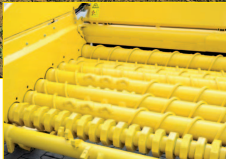
Aparte aandrijvingen voor 3 rollen sets met individuele snelheidsregeling en automatisch reviseren bij steen Klemming
