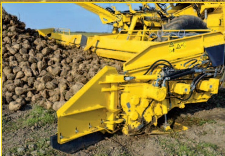
Aparte aandrijvingen voor 3 rollen sets met individuele snelheidsregeling en automatisch reviseren bij steen Klemming
