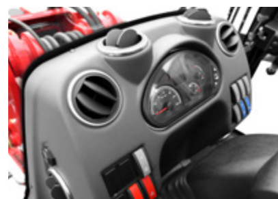
Vernieuwd ventilatiesysteem met grotere openingen voor optimale luchtcirculatie
