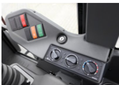
Nieuwe bedieningsconsole; eenvoudig bereikbaar met alle functies binnen handbereik
