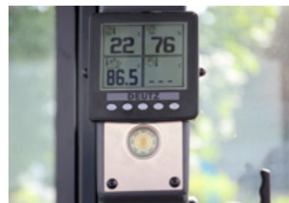
Nieuw infodisplay in de B-zuil voor het motormanagement
