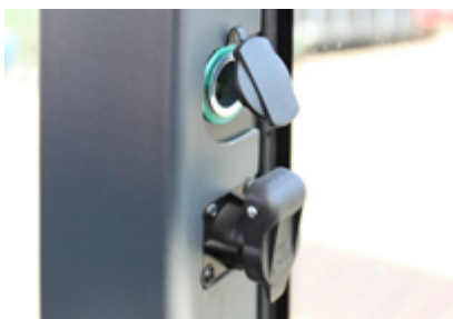
12 volt stekker voor het opladen van mobiele toestellen en een 3 polige 12 volt aansluiting
